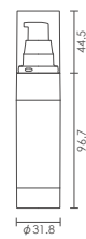
HB019-030R 内容量 | 30ml O F | 33.0ml 材質 | PP,PE 成形方法 | インジェクション
